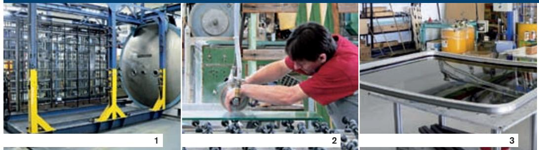
**d 1 Hochleistungsanlage:** In den Vakuumkesseln wird das Glas durch Wernberger Thermische Bedampfung veredelt. **2 Präzisionsarbeit:** Durch Fräsen, Schleifen oder Schneiden wird jede gewünschte Scheibenform realisiert. **3 Qualitätsmaßstab:** In der Spritzanlage wird die Scheibe mit dem Modul verklebt.
